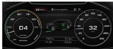
Rekuperation beim Bremsvorgang Energy recovery when braking 03/16
