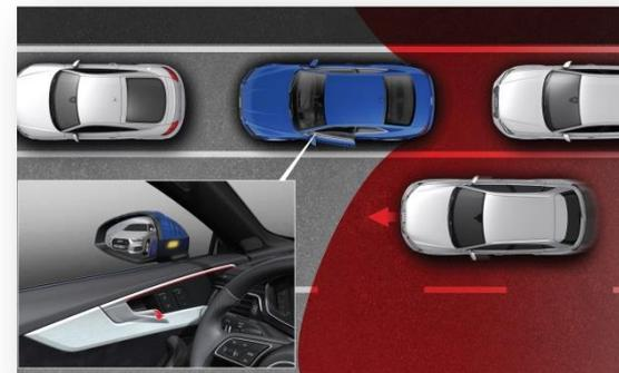
**Audi pre sense basic** déploie automatiquement, lorsque nécessaire, des mesures préventives parmi lesquelles : resserrement des ceintures de sécurité à l'avant afin de limiter tout déplacement des passagers vers l'avant ou les côtés, activation des feux de détresse clignotants, de la fermeture du toit ouvrant panoramique en verre (si commandé) et de celle des vitres latérales.
