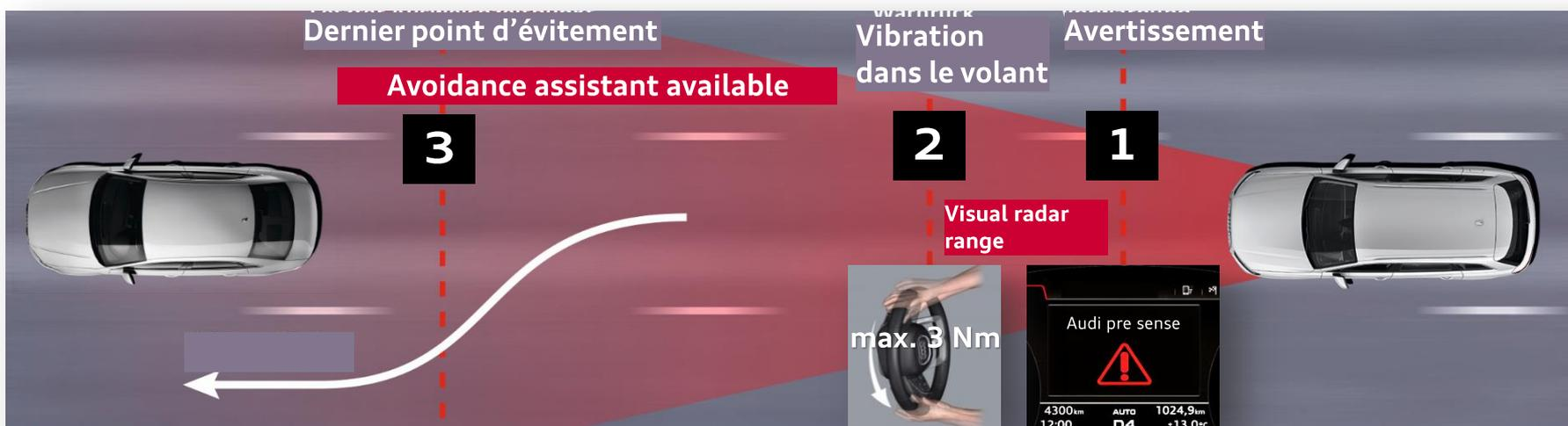
C'est un élément de l'Audi pre sense front. Il intervient sur la direction pour aider le conducteur lors d'une manœuvre d'évitement.
